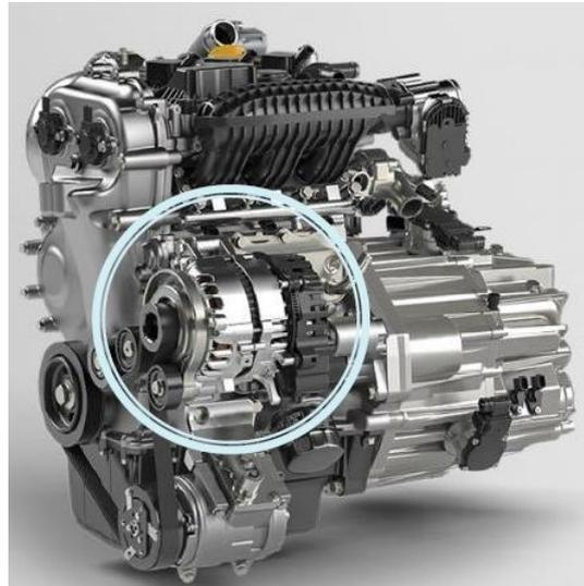
Figura 1.13-Esempio di installazione P1F
