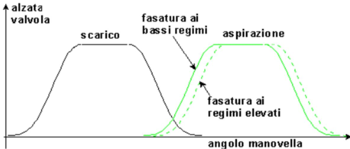
Figura 2.37-Principio di funzionamento del sistema di fasatura variabile VVT [59]
