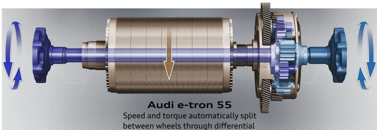
Figura 4.59-Schema e funzionamento PWT posteriore Audi E-tron 55 [42]
