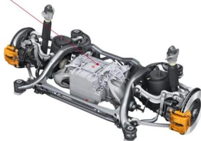
Figura 4.52-Posizione del motopropulsore elettrico sull'assale posteriore [42]
