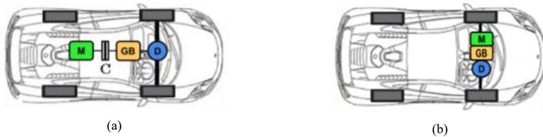
Figura 4.3- Configurazione dei veicoli elettrici dovuta alla variazione nella disposizione del sistema di propulsione
