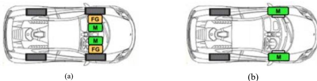
Figura 4.5- Configurazione dei veicoli elettrici dovuta alla variazione del tipo di trasmissione della potenza
