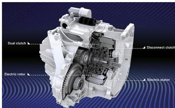
Figura 5.9-Cambio a doppia frizione 8F-DCT [27]
