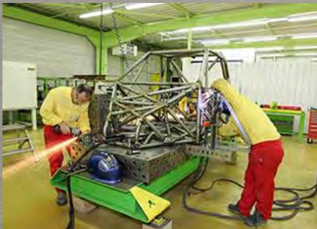
TELAIO A TRALICCIO IN TUBI DI ACCIAIO
